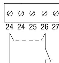
Прерывание измерения во время наполнения. Для использования удалите перемычку.
