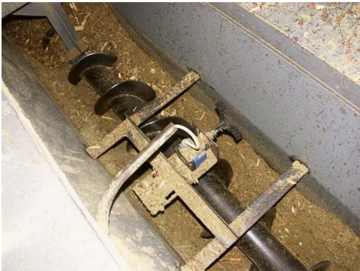
Рис. 4. Пример установки ротационного датчика уровня UWT RN 4001 для контроля уровня древесных отходов в шнековом желобе
